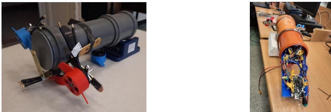
25-26. ábra: A tengeralattjáró váza és a kibúvott vezérlőtábla.
